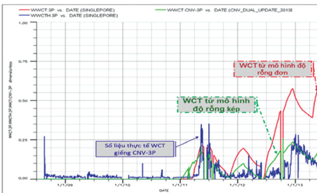
Hình 8. So sánh khả năng mô phỏng động thái ngập nước giếng CNV-3P giữa mô hình độ rỗng đơn và độ rỗng kép với số liệu thực tế khai thác
