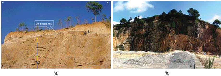
Hình 2. Đới phong hóa có bề dày từ 2 - 5m nằm dưới là 2 hệ thống khe nứt gần thẳng đứng và nằm ngang với mật độ khá cao: Núi Lớn, Vũng Tàu (a) và Trại Mát, Đà Lạt (b)
