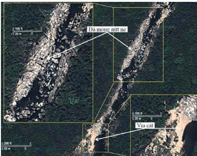
Hình 6. Dòng sông xuyên cắt khối đá móng nứt nẻ (sáng màu) với những thân cát kích thước nhỏ (màu vàng sáng) kề áp (khu vực Hầm Hồ - Bình Định)
