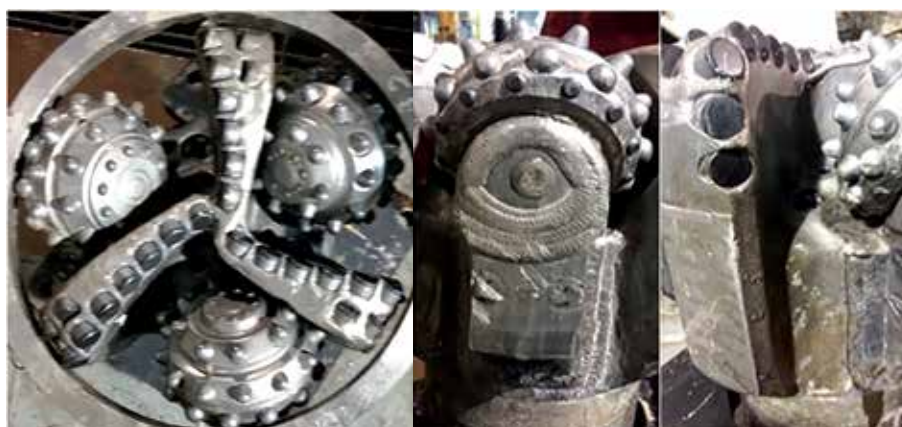
Hình 3. Tình trạng chòong khoan Kymera kéo lên sau một hiệp khoan (khoan được 516m)
