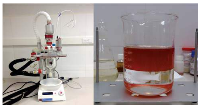
(a) Thiết bị phản ứng (b) Sản phẩm sau quá trình trung hòa acid
