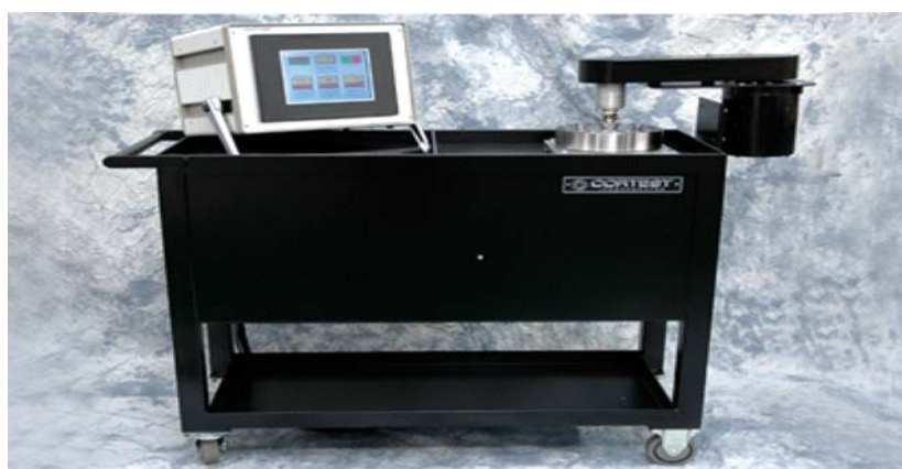
Hình 2. Thiết bị đánh giá tốc độ ăn mòn bằng phương pháp mất khối lượng
